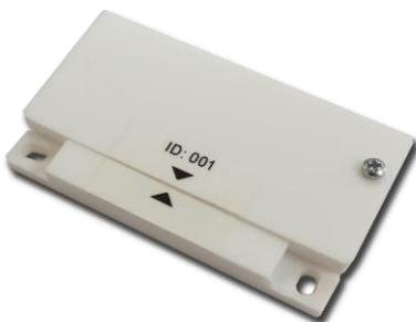
Bežični osjetnik (senzor) služi za detekciju statusa prozora ili vrata. Uparuje se s baznom stanicom koja statuse prenosi KLIMAZONE-S kontroleru. Uz bežični osjetnik montira se i magnet i to tako da je magnet na krilu prozora, a osjetnik na okviru (preporučeno).
